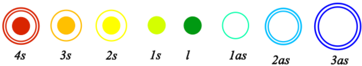
Рис.1.7. Схематичне зображення плям пучків випромінювання компонент вимушеного раманівського розсіяння і лазерного збудження.
